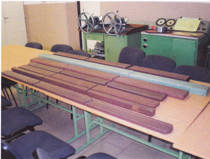
Obr. 21 Vybrané profily na skúšku rázovej húževnatosti metódou Charpy a skúšku tvrdosti Shore
