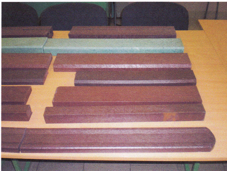
Obr. 22 Rozdelené profily na skúšku rázovej húževnatosti metódou Charpy a skúšku tvrdosti Shore
